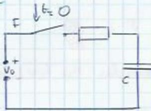
\* Op  $t=0$  wordt een weerstand en een ongeladen condensator aangesloten op een constante spanning  $V_0$
